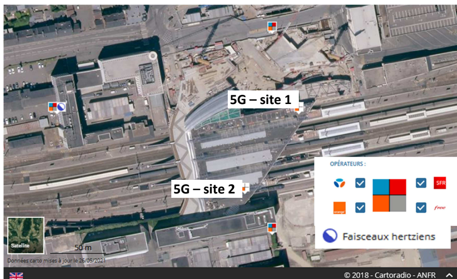
Figure 6 : extrait de Cartoradio pour visualiser les stations radioélectriques autorisées par l'ANFR autour de la gare de Rennes
